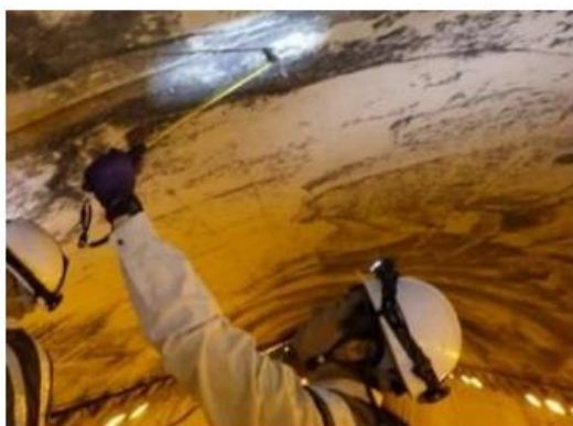
打音検査による変状の把握（従来手法）
