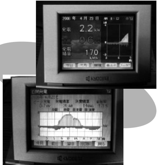
各社から出されているモニターを使うと発電量、消費量、売電・買電状況までひと目で確認できます。また、石油換算の消費削減量や、CO2排出削減量も表示されます。
