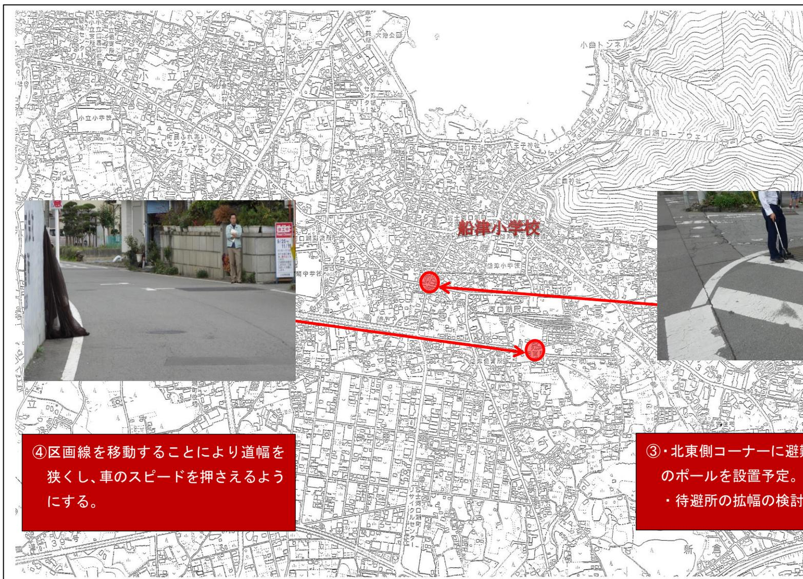
④区画線を移動することにより道幅を狭くし、車のスピードを押さえるようにする。
