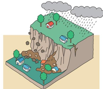
地面にしみ込んだ水分が土の抵抗力を弱め、弱くなった斜面が突然崩れ落ちるのががけ崩れです。突発的に起こり、瞬時に崩れ落ちるので、逃げ遅れる人も多く、被害が大きくなります。
