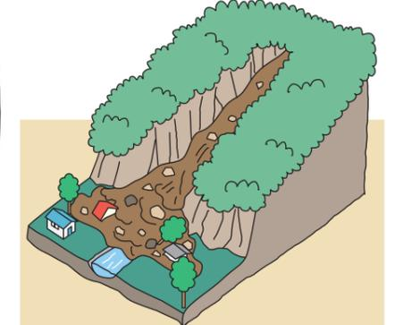
谷や斜面にたまった土や石、砂などが、大雨による水と一緒に一気に流れだして起こります。破壊力が大きく、また流れる速度も速いため、大きな被害をもたらします。
