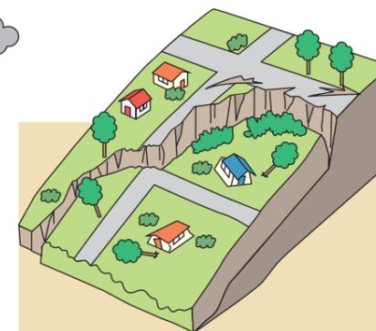
比較的緩やかな斜面において、地中の粘土層などの滑りやすい面が地下水などの影響で、ゆっくり動き出す現象です。一度に広範囲で発生するために、住宅や道路、鉄道などに大きな被害をおよぼします。
